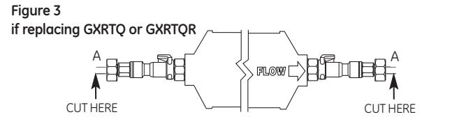
**NOTE:** Si vous remplacez un modèle de GXRTQ ou GXRTQR, coupez la tuyauterie à **A** comme représenté sur la figure 3 au-dessus, suivez alors les instructions d'installation ci-dessous.
