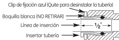
9. Saque la tubería ligeramente para asegurar un buen sellamiento.
